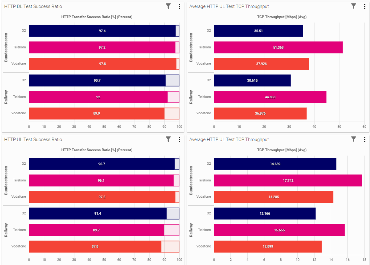
Abbildung 51: HTTP Transfer einer einzelnen Datei der Größe 5 MB (DL - oben), bzw. 2 MB (UL - unten).
