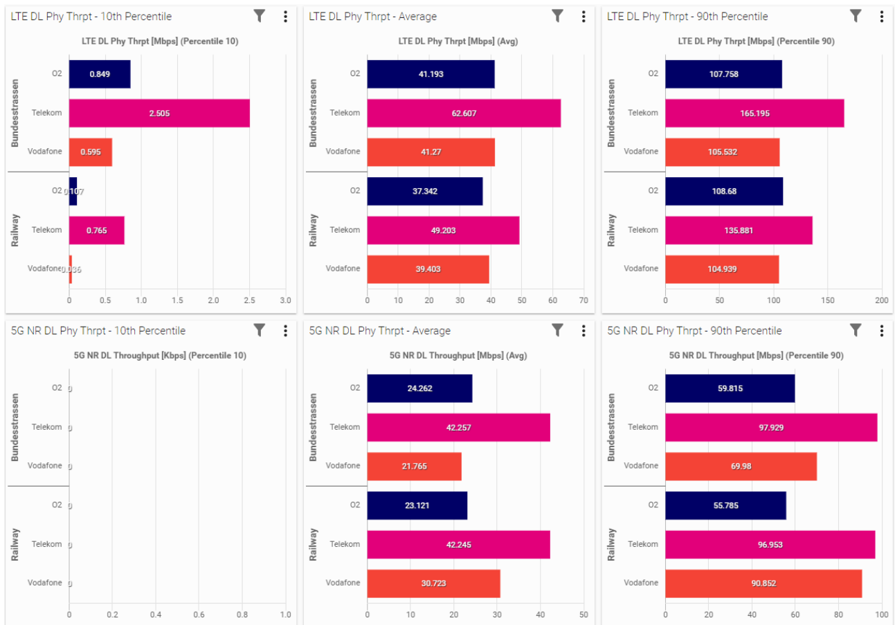
Abbildung 48: Aufteilung der Beiträge aus LTE (oben) und 5G (unten) pro Netzbetreiber und Kategorie.
